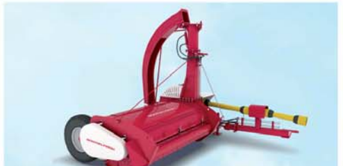
საკვებდამამზადებელი მისაგმელი კომპანი STERH 2000 წარმადობა – 38 ტ/სთ. სამუშაო სიჩქარე – 7,2 კმ-მდე/სთ.
