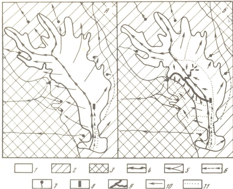
Р и с. 16. Схема движения подземных вод на Долгоруковском массиве (А — по Е.А. Зубровой [104]; Б — по В.Н. Дублянскому [13])
