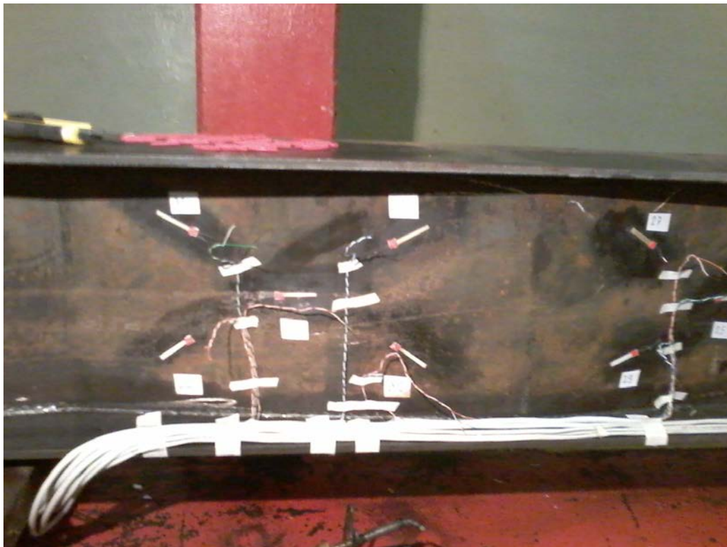
ნახ. 40 ტენზომეტრები შვეულ კედელზე
