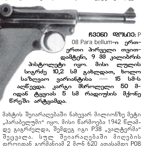
ჩინური დროს: P 08 Para bellum-ი ერთ-ერთი პირველი თვით-დაამტეხი, 9 მმ კალიბრის პისტოლეტი იყო. მისი ლულის სიგრძე 10,2 სმ გახლდათ, ხოლო საზღვაო ვარაზნისა — 15 სმ-ს აღწევდა. კარგი მსროლელი 50 მ-იდან ტყვიას 5 სმ რადიუსის მქონე წრეში არტყამდა.
