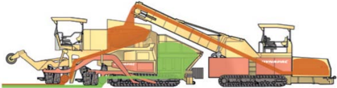
ნახ. 26. ასფალტბეტონის ორი ფენის ერთდროულად მოწყობის ტექნოლოგიური ხაზი
