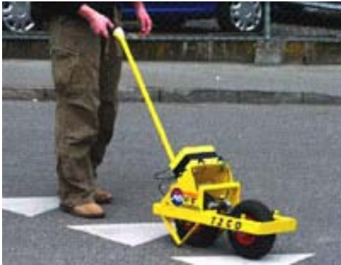
ნახ. 5. ჩაჭიდების კოეფიციენტის განსაზღვრელი ხელის საგორავი მოწყობილობა.
