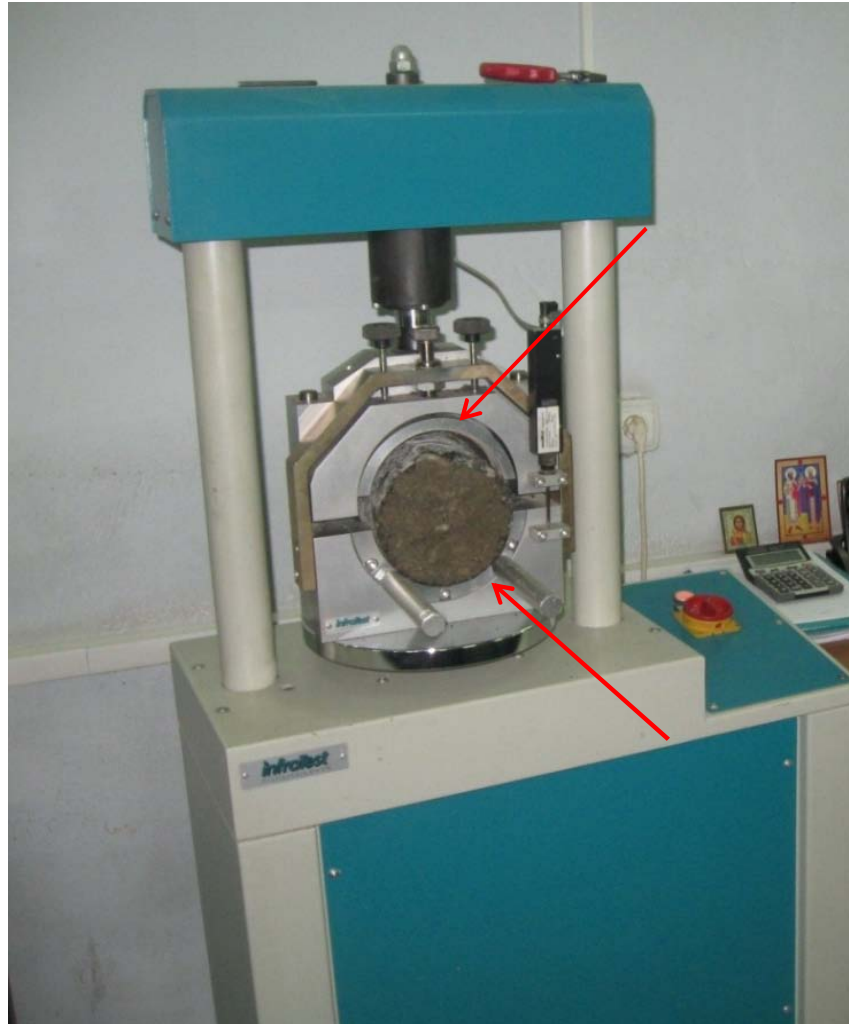
ნახ. 27. ასფალტბეტონის ფენებს შორის შეჭიდულობის ძალის გასაზომი მოწყობილობა.
