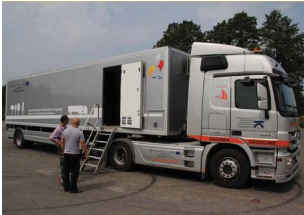
ნახ. N 7. მზიდუნარიანობის განმსაზღვრელი ავტომობილი დეფლექტომეტრი.
