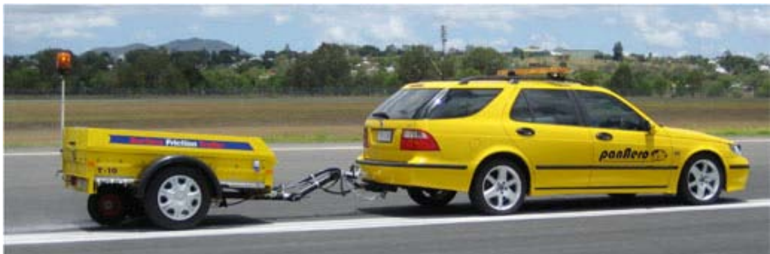
ნახ. N 6. ავტომობილზე გამოსაბმელი ჩაჭიდების კოეფიციენტის განსაზღვრის მოწყობილობა.
