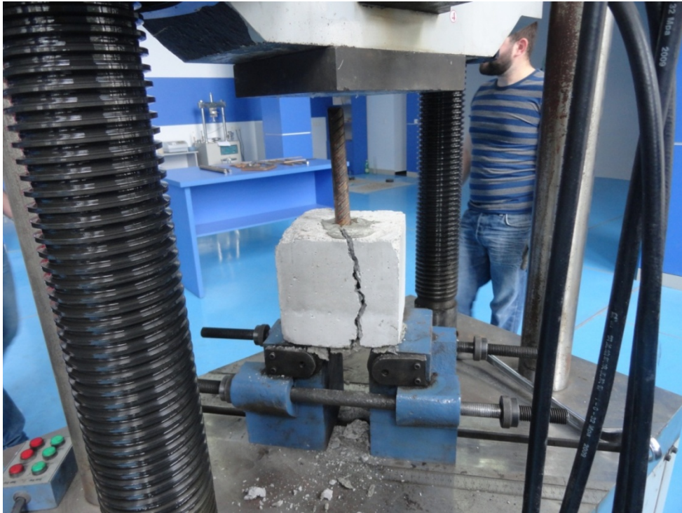
ნახ. 6.10 არმატურის ბეტონთან შეჭიდულების გამოცდა
