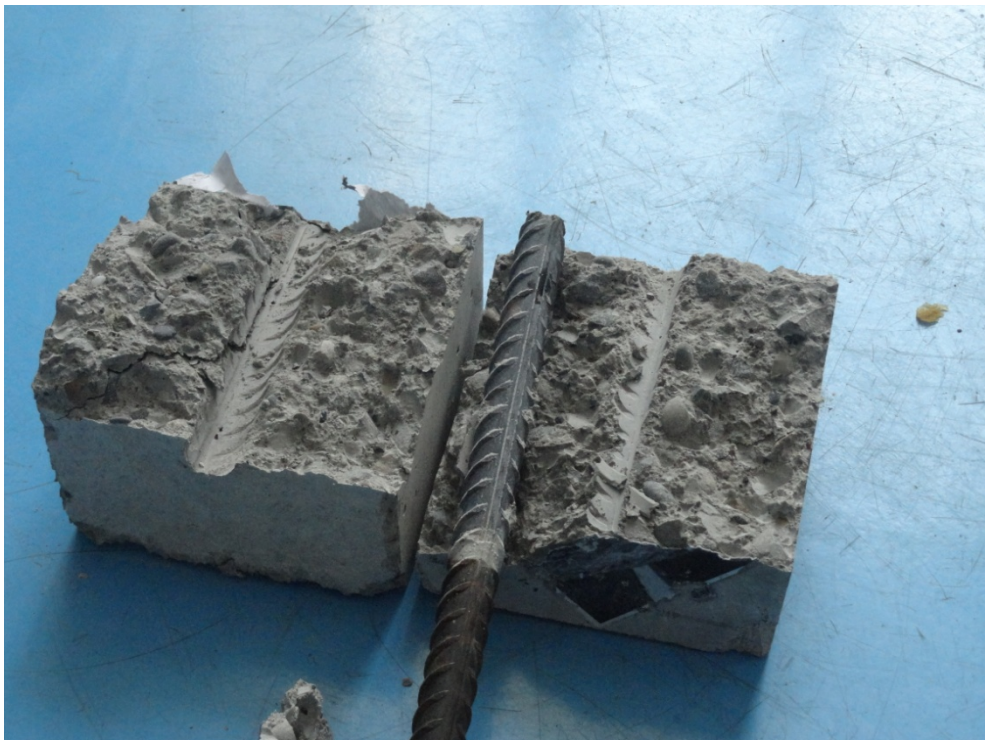
ნახ. 6.10 არმატურის ბეტონთან შეჭიდულების გამოცდა
