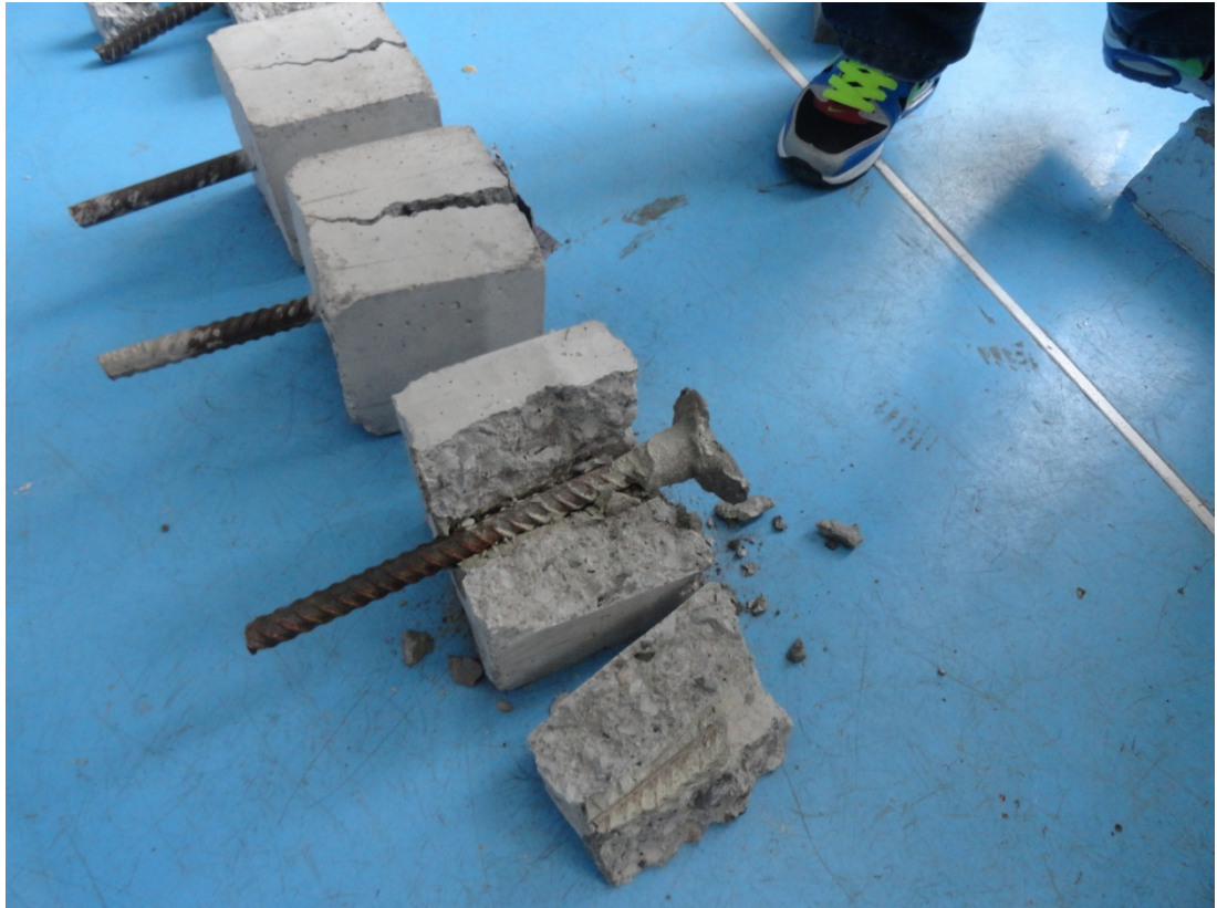
ნახ.6.12 გამოცდილი გოგირდბეტონიანი ნიმუშები
