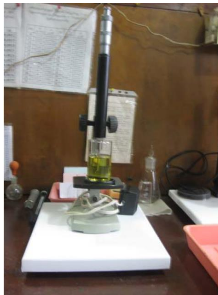
ნახ. 16 ტრანსფორმატორის ზეთის ზედაპირული დაჭიმულობის გასაზომი ხელსაწყო
