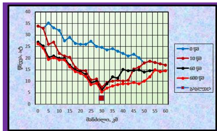
ნახ. 28. მილსადენში, სხვადასხვა დროისათვის, წნევი პროფილები მსხვილი ბზარისას, 40 კმ მანძილზე ([69]): ◆ - 0 წმ; ■ - 10 წმ; ▲ - 1 წთ; * - 10 წთ
