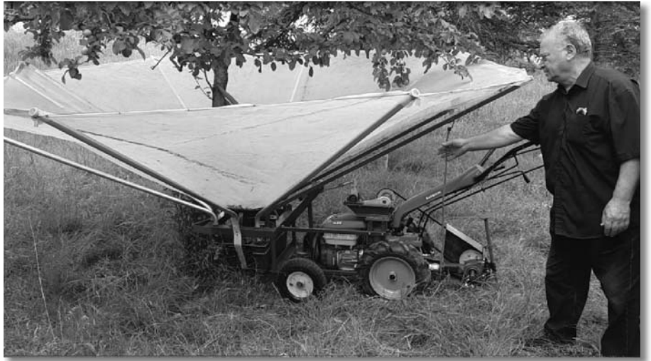
სურ.2 მანქანა ძირითადად შედგება სამი მექანიზმისაგან. 1. ამძრავი მექანიზმი – რედუქტორი და ლველური გადაცემა; 2. მბერტყავი მოწყობილობა – მექანიკური, ექსცენტრული ვიბრატორი; 3. ნაყოფდამჭერი მოწყობილობა – გასაშლელი ფარდაგი (ბადე) ყუთით.
