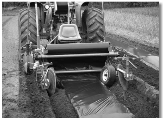
სურ. 3 ბაზონარმომქმნელი, წვეთოვანი სისტემის გამყვანი და პლასტიკური მულჩის დამგები კომბინირებული აგრეგატი
