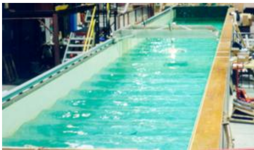
ნახ. 3.4. ნაპირგასწვრივი ტალღები ლაბორატორიულ პირობებში
