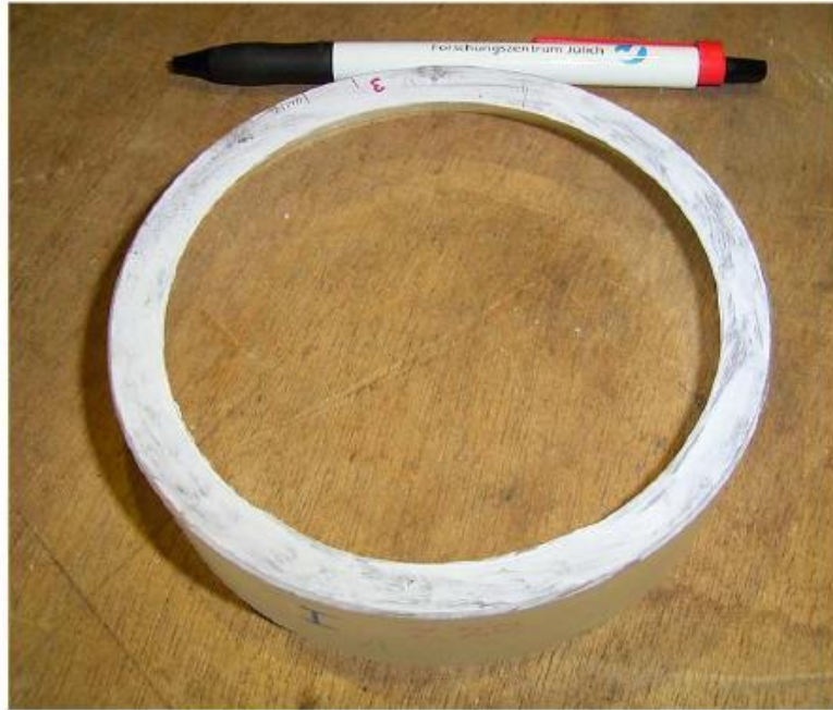
ნახ. 34. იულიხის კრისტალური სპექტრომეტრის კვარცული კრისტალი
