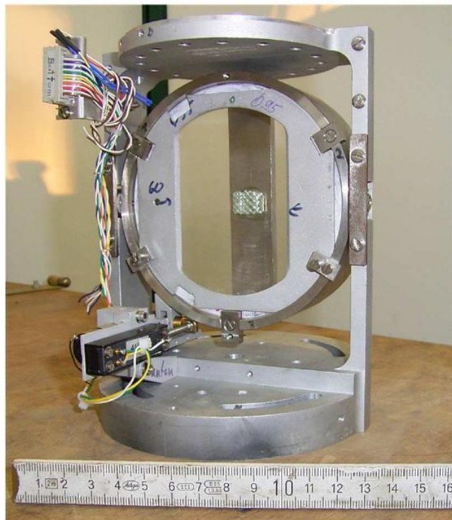
ნახ. 33. იულიხის კრისტალური სპექტრომეტრის კრისტალი მეტალის ლიობით
