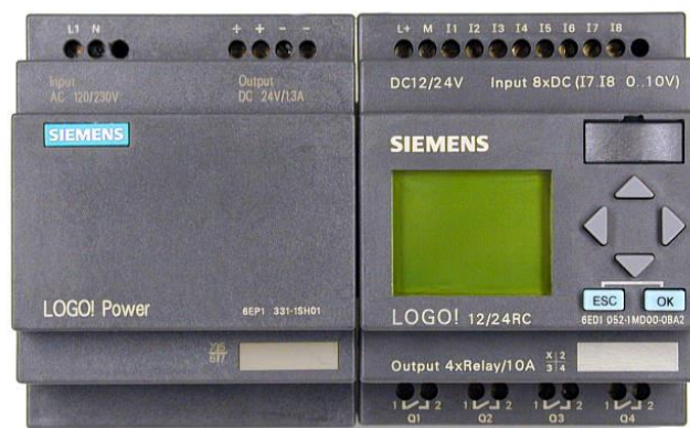
ნახ. 6. პროგრამირებადი ლოგიკური კონტროლერი (PLC)
