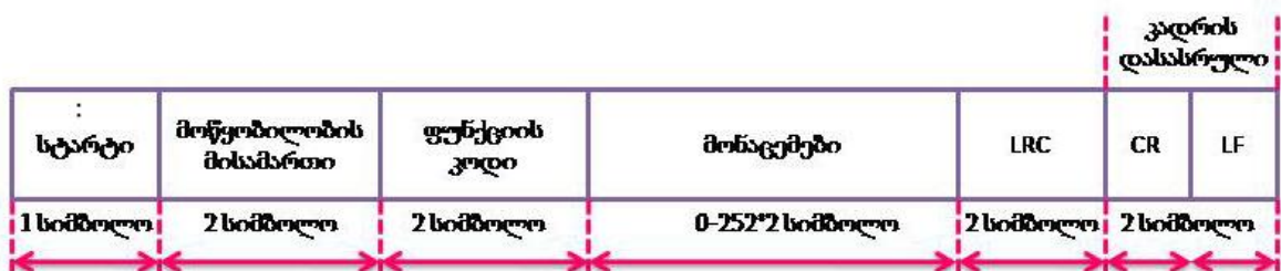
ნახ. 17. Modbus ASCII კადრის ფორმატი
