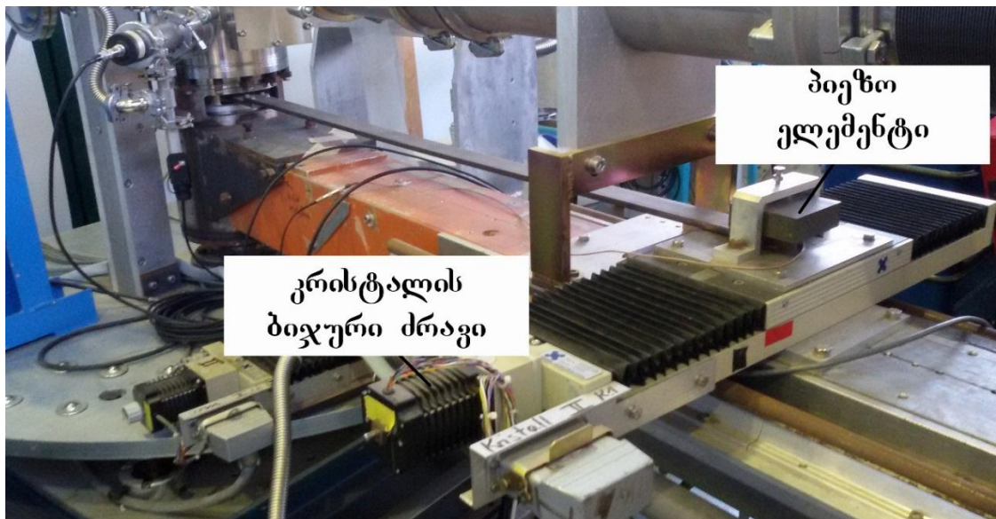
ნახ. 57. პიეზო ელემენტის დამჭერი და კრისტალის ბიჯური ძრავი
