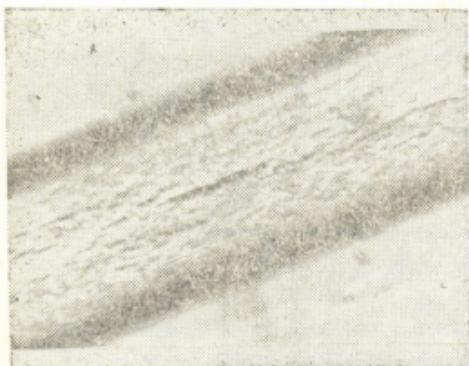
Рис. 4 б. Продольный вид капроновой мононити. Экспозиция 12 мес. Стабилизатор ДХГИ
