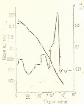
Рис. 3. Интегральная и дифференциальная кривые порограммы нанесенного медьхроммарганцевого катализатора, прокаленного при 543—573 К (3)
