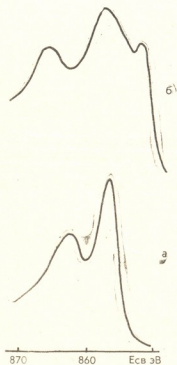
Рис. 3. Спектры линии Ni 2p 3/2 6% Ni—3% Cr МКл, снятие при: а) 25°C и б) 450°C
