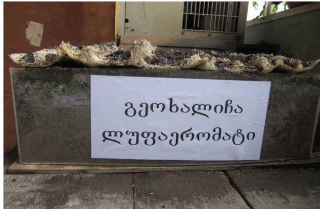
ფოტო 1. ეროზირებული ფერდობიდან მოტანილი ნიადაგ-გრუნტით შევსებულ პოლიეთილენის ყუთზე დაფენილი გეოსალიჩა ლუფაერომატის საერთო ხედი
