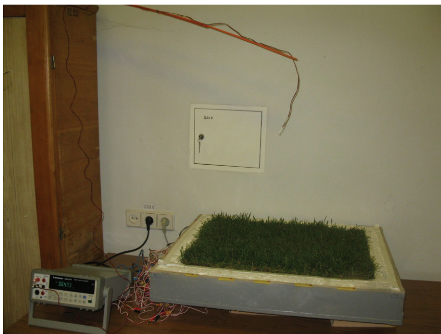
Рис. 3. Полностью укомплектованная физическая модель экстенсивной зеленой кровли
