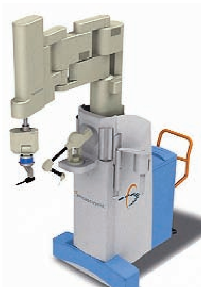
სურათი 9. რობოტი-ქირურგი ROBODOC
