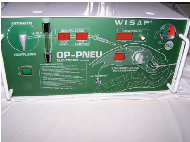
სურათი 7. K. Semm-ის და ფირმა WISAP- ის თანამშრომლობით შექმნილი პირველი ელექტრონული ინსუფლატორი (1969 წ)
