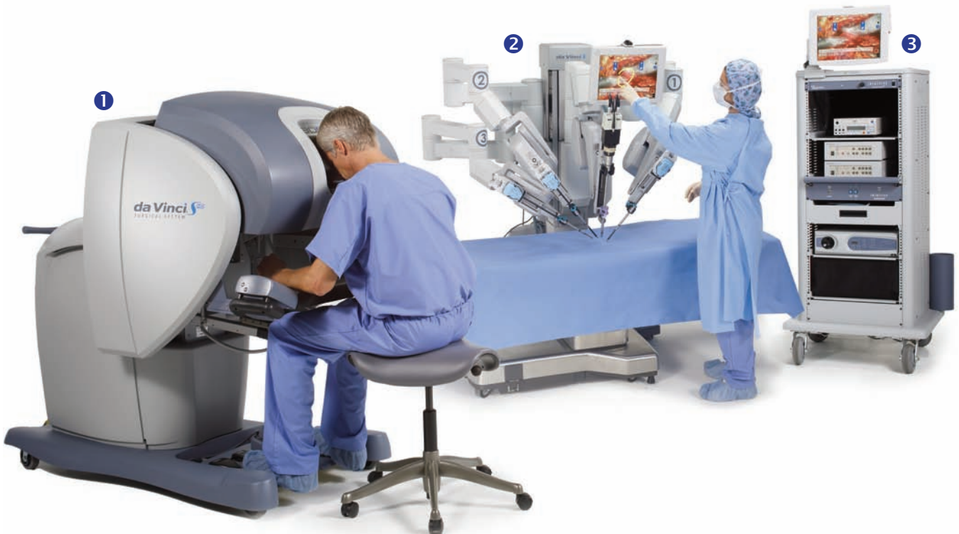
სურათი 44. რობოტული სისტემა da Vinci : 1. ქირურგის კონსოლი; 2. რობოტი-მანიპულატორი; 3. ენდოსკოპიური აპარატურის ურიკა
