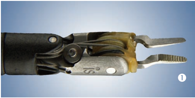
სურათი 49. 1. 360° ბრუნვისა და შვიდი მიმართულებით როტაციის იარაღი; 2. იარაღის მოძრაობა ხელის მოძრაობის შესაბამისად
