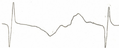
Рис. 4. Спектр ЭПР \gamma -облученной сахарозы, записанный совместно с внутренним марганцевым стандартом
