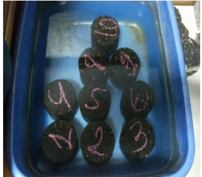
ნახ.18 ლაბორატორიაში სხვადასხვა მარკის ბიტუმით დამზადებული ასფალტბეტონის ცილინდრების ფორიანობის განსაზღვრის პროცესი
