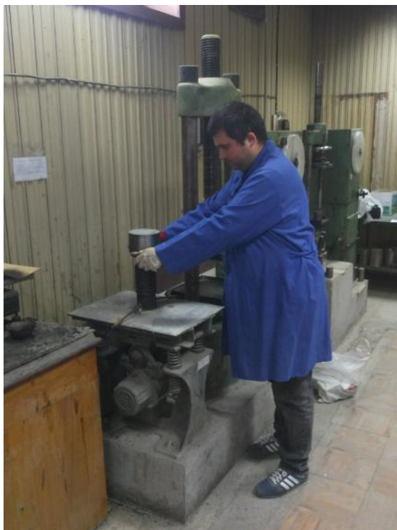
ნახ.17 ლაბორატორიაში ასფალტბეტონის ცილინდრების სხვადასხვა მარკის ბიტუმით დამზადების პროცესი
