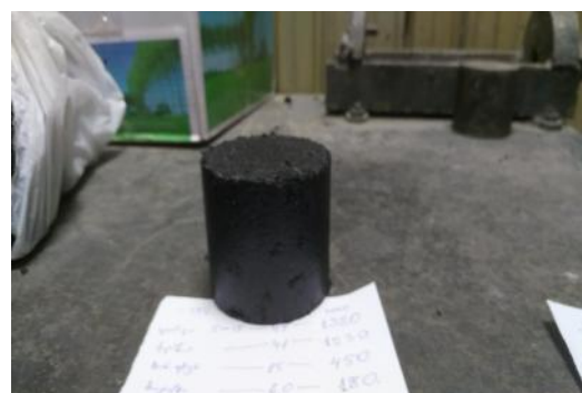
ნახ.17 ლაბორატორიაში ასფალტბეტონის ცილინდრების სხვადასხვა მარკის ბიტუმით დამზადების პროცესი
