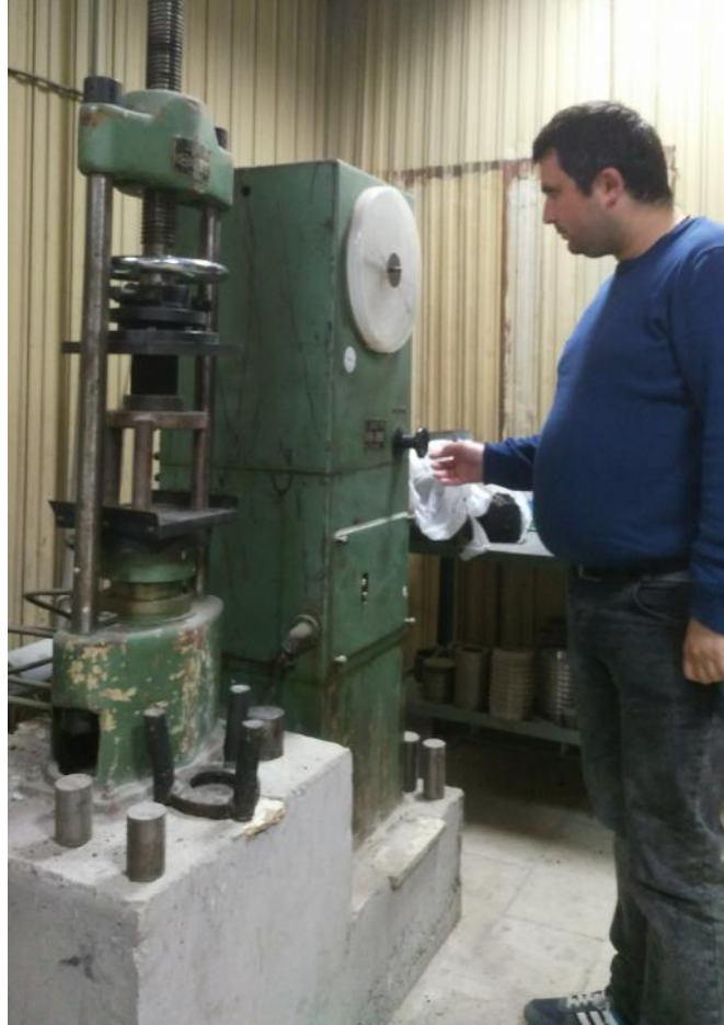
ნახ.19 ლაბორატორიაში სხვადასხვა მარკის ბიტუმით დამზადებული ასფალტბეტონის ცილინდრების კუმშვაზე გამოცდის პროცესი
