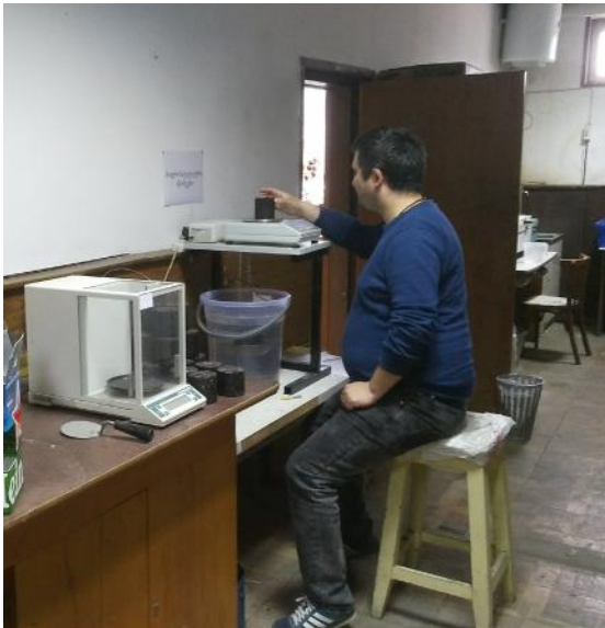
ნახ.18 ლაბორატორიაში სხვადასხვა მარკის ბიტუმით დამზადებული ასფალტბეტონის ცილინდრების ფორიანობის განსაზღვრის პროცესი
