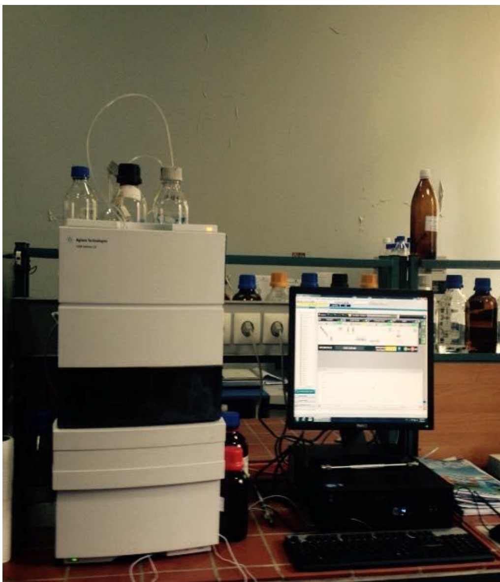
სურ. 15 : Agilent 1290 სერიის ზე-მაღალი ეფექტურობის სითხური ქრომატოგრაფი (U-HPLC)
