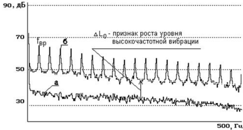
ნახ.2.11.სრიალის საკისრის ვიბრაციების შემომვლელის სპექტრი. ა) დეფექტის გარეშე; ბ) საკისარში დარტყმების შემთხვევაში
