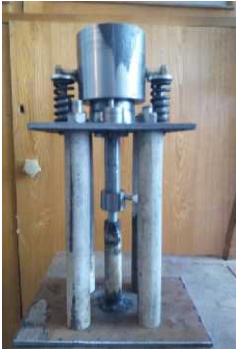
ნახ.1. რადიალური მოჭიმვის მოწყობილობის ფოტოსურათი და სქემა: 1,2. სადგარის ქვედა და ზედა 2 ფილები; 3. მილისებრი კოლონა; 4. სარქი; 5. მიმმართველი შტიფტი; 6. დამწოლი მილისა; 7. კონუსური მომჭერი; 8. ზამბარა; 9. ჭანჭიკი; 10. ხრახნით; 11. ნამზადის დამჭერის ბუდე; 12. ჭანჭიკი
