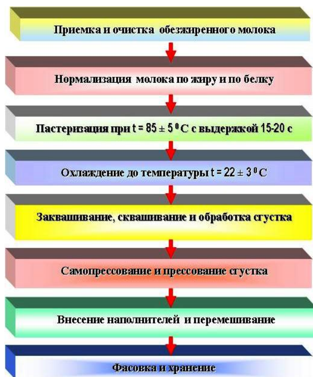
Рисунок 1 - Блок-схема технологического процесса производства белковой пасты
