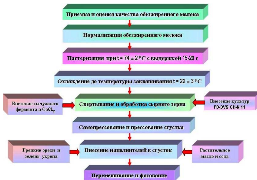
Рисунок 2 - Блок-схема технологического процесса производства пастообразного мягкого сыра
