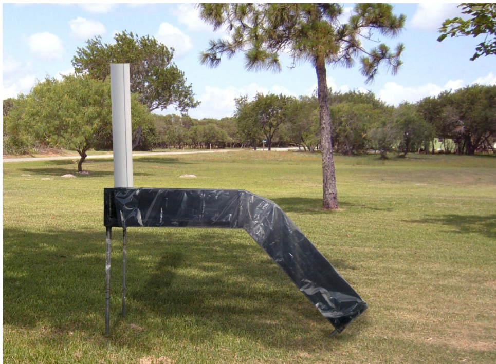
Рис. № 3. Конвективная гелиосушилка
