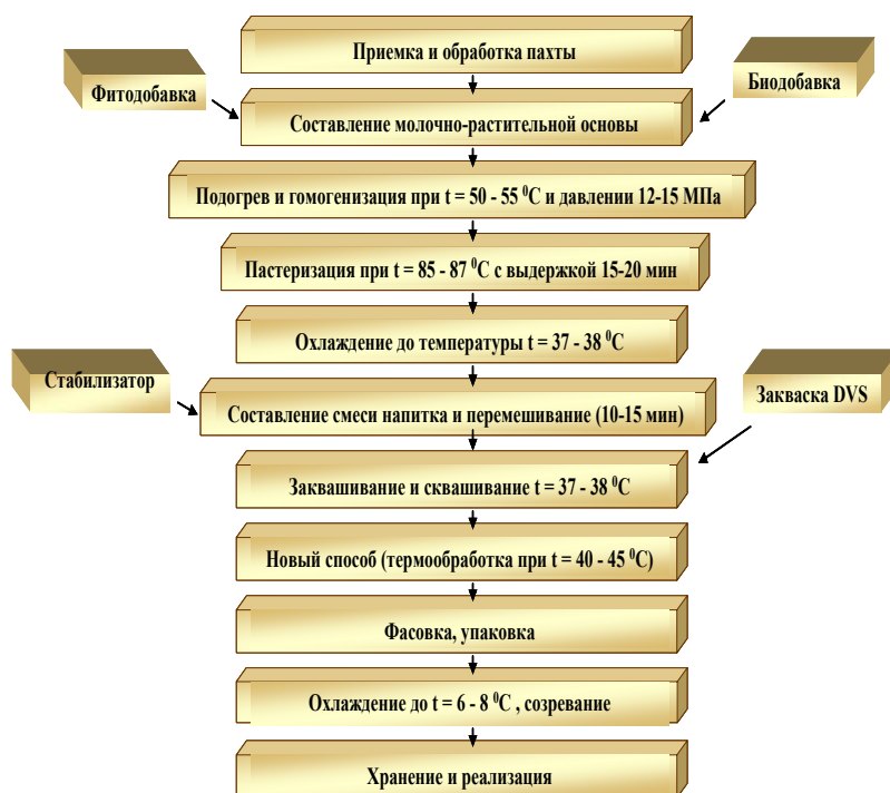
Рисунок 3 - Блок-схема технологического процесса производства кисломолочных напитков
