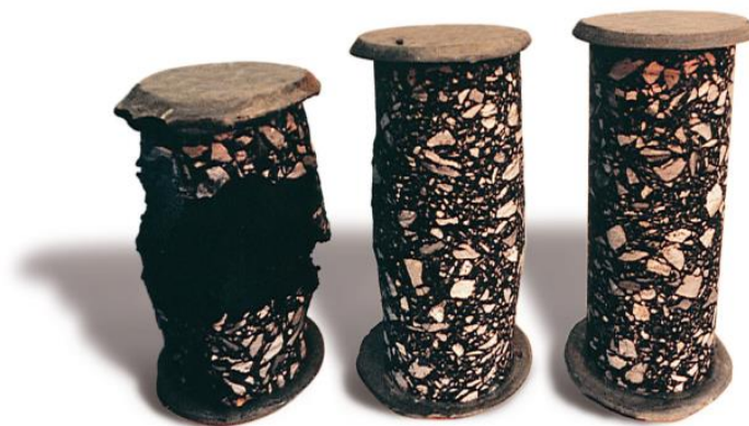
ნახ.6 არამოდიფიცირებული და ელვალის პოლიმერით მოდიფიცირებულ ბიტუმებით დამზადებული ასფალტბეტონის ნიმუშების გამოცდის შედეგები
