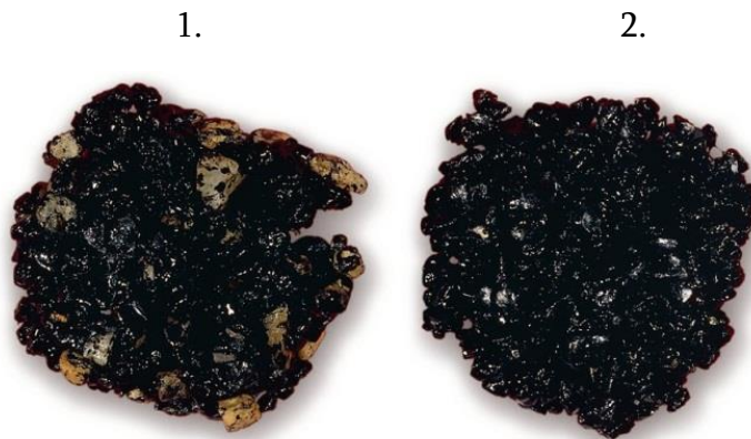
ნახ. 5. არამოდიფიცირებული და ელვალის პოლიმერით მოდიფიცირებული ბიტუმებით დამზადებული ასფალტბეტონის ნარევი 1. არამოდიფიცირებული ბიტუმით; 2. ელვალით მოდიფიცირებული ბიტუმი
