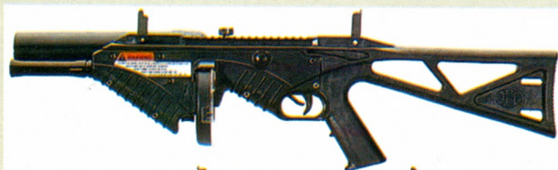
FN 303-ის მოდული M16 ტიპის საიერიშო შაშხანის ღულის ძველად მაგრდება, როგორც M203 ტიპის ყუმბარსატყორცნი
