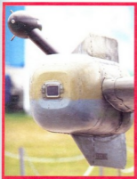
შარშანდელ მოსკოვის ავიაციის დეპარტამენტი Ka-52. მარცხენა ფოტოზე — გადასატანი კომპლექსიდან რაკეტის გასროლის დამაფიქსირებელი დეტექტორი, ქვედა ფოტოზე — სისტემა MANTA-ს ლაზერული დანადგარი
