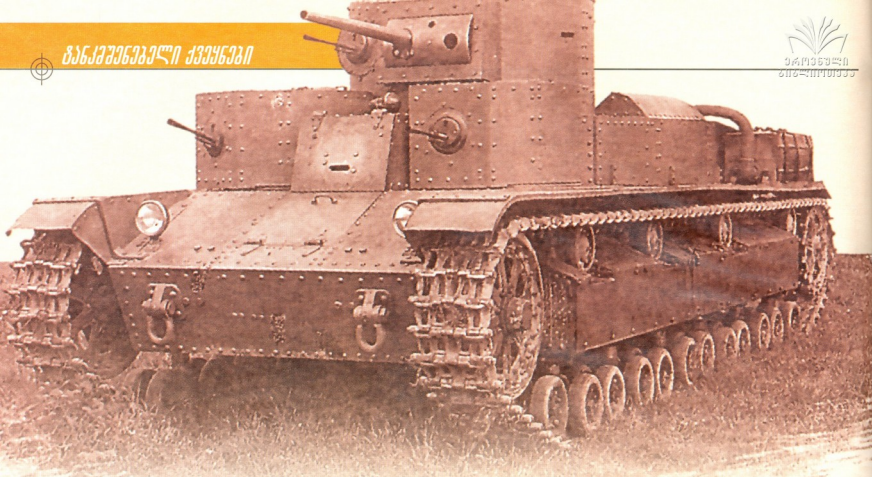
T-28: მასა – 25,4 ტონა, ვეიპაიუ – 6 კაცი, ჯავშანი – 10-30 მმ, კარბურატორიანი ძრავა – 450ცხ.ძალიანი, სიჩქარე – 20-42 კმ/სთ-ში, სვლის მარაგი – 120-190 კმ, შეიარაღება – 76 მმ-იანი ქვემეხი და ოთხი-ხუთი 7,62 მმ-იანი ტყვიამფრექვეო
