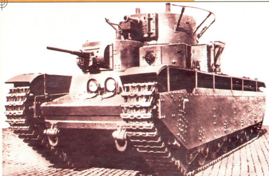
T-35: მასა – 50,0 ტონა, ეკიპაჟი – 11 კაცი, ჯგუფანი – 20-30 მმ, კარბურატორიანი ძრავა – 500ცხ.ძალიანი, სიჩქარე – 30 კმ/სთ-ში, სვლის მარაგი – 150-200 კმ, შეიარაღება – 76 მმ-იანი და ორი 45 მმ-იანი ქვეშები, ზუთი 7,62 მმ-იანი ტყვიამფრქვევი
