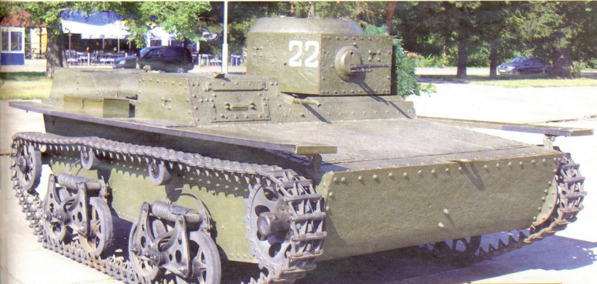
T-38: მასა – 3,3 ტონა, ეკიპაჟი – 2 კაცი, ჯავშანი – 9 მმ, კარბურატორიანი ძრავა – 40 ცხ.ბალანი, სიჩქარე – ხმელეთზე 40 კმ/სთ-ში და წყალში 6-7 კმ/სთ-ში, ხელის მარაგი ხმელეთზე – 220-230 კმ, შეიარაღება – 7,62 მმ-იანი ტყვიამფრევეები
