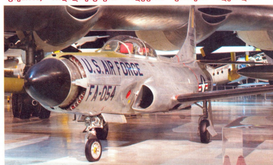
F-96C-ზე 24 უმართავი რაკეტის განთავსება, ცხვირში, რადიოლოკაციური სადგურის გარშემო ხდებოდა
