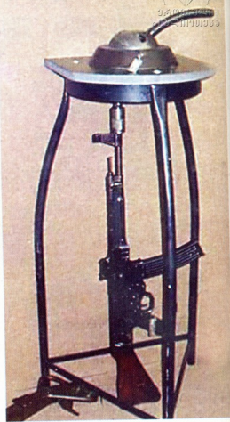
1943 წელს ვერმახტმა ოფიციალურად მიიღო შეიარაღებულმა მოწყობილობა Krummerlauf-ი — „მოხრილი ლულა“, რომელიც ავტომატურ საიერიშო შაშხანა Schmeisser Stg 44-ს წინ უმაგრდებოდა
