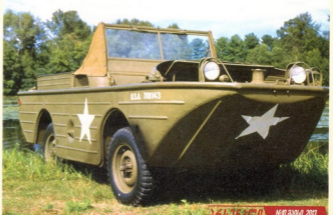
GPA: მასა — 1600 კგ, ტევადობა — მძღვლი და 3 კაცი, კარბურატორიანი ძრავა 60-ცხ.ძალიანი, სიჩქარე ხმელეთზე/წყალში — 89/9 კმ-სი-ში
