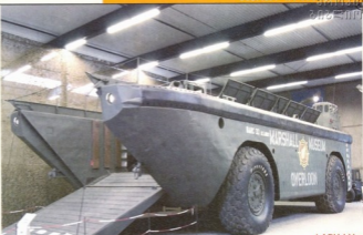
LPAK-LX: სრული მასა — 100 ტ, 265-ცხ.ძალიანი დინამოს 4 ძრავა, სიჩქარე ხმელეთზე/წყალში — 32/12 კმ-სი-ში, სვლის მარაგი ხმელეთზე/წყალში — 240/120 კმ
