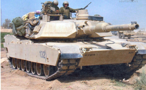
M1A2: მასა — 61,3 ტ, ვეიპაფი — 4 კაცი, აირტურბინა 1500-ცხ. ძალიანი, სიჩქარე — 48/70 კმ/სთ-ში, სვლის მარაგი — 410 კმ, შეიარაღება — 120 მმ-იანი ქვეუბი, 12,7 მმ-იანი და ორი 7,62 მმ-იანი ტყვიამფრქვევი
