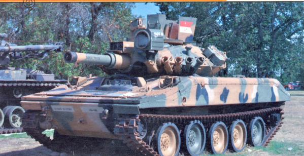
M551: მასა — 15,2 ტ, ეკიპაჟი — 4 კაცი, ჯავშანი — ტყვიამუდვი, დიზელის ძრავა 255-ცხ. ძალიანი, სიჩქარე — 69 კმ/სთ-ში, სელის მარაგი — 564 კმ, შეიარაღება — 152 მმ-იანი ქვერეზი, 12,7 მმ-იანი და 7,62 მმ-იანი ტყვიამფრეშვეები
