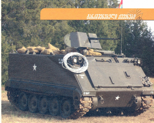
M113A1: მასა — 12,3 ტ, ეკიპაჟი — 2 კაცი, დენსტრი — 11 კაცი, ალუმინის ჯეჰანი — 12-38 მმ, დიზელის ძრავა 275-ცხ.ძალიანი, სიჩქარე ხმელეთზე/წყალში — 67,6/5,8 კმ/სთ-ში, სვლის მარაგი შოსეზე — 480 კმ, შეიარაღება — 12,7 მმ-იანი ტყვიამფრეველი და სხვ.
