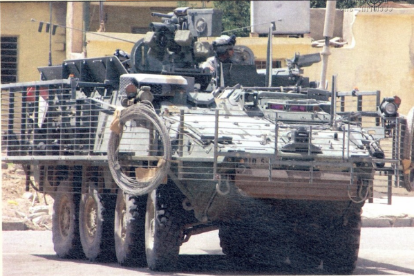
Stryker-ი: მასა — 17,2 ტ, ეიაბაი — 2 კაცი, დესანტი — 9 კაცი, დიზელის ძრავა 350-ცხ.ძალიანი, სიქარე — 97,0 კმ/სთ-ში, სელის მარავი — 500 კმ, შეიარალება — 12,7 მმ-იანი ან 7,62 მმ-იანი ტყვიამფრეველი, ან 40 მმ-იანი ეუმპარასატყორცი
