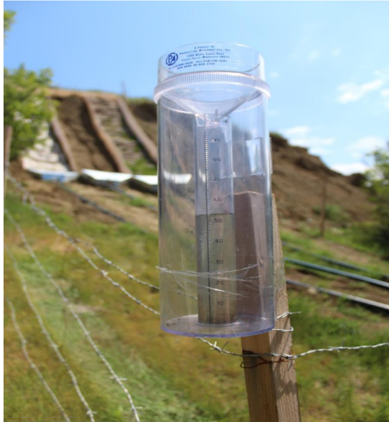
ფოტო 2.2.1 საველე ინტეგრირებული პოლიგონის სიახლოვეს დამონტაჟებული პლუვიოგრაფი
