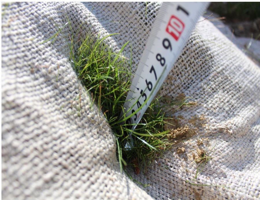
ფოტო 2.2.5 გეოხალიჩა “Jute Mat”-ზე ამოსული მცენარეების სიმაღლის გაზომვის პროცესი
