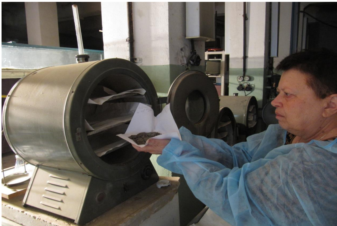
ფოტო 2.2.4 ლაბორატორიულ პირობებში ეროზირებული ნიადაგ-გრუნტის წონის დადგენა
