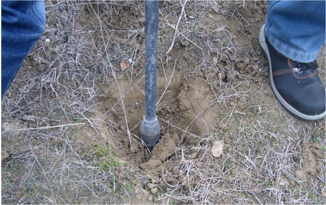
ფოტო 2.2.3 საკვლევი ინტეგრირებული პოლიგონის საკონტროლო (ეროზირებული) უბნიდან ნიადაგ-გრუნტის სინჯების აღების პროცესი
