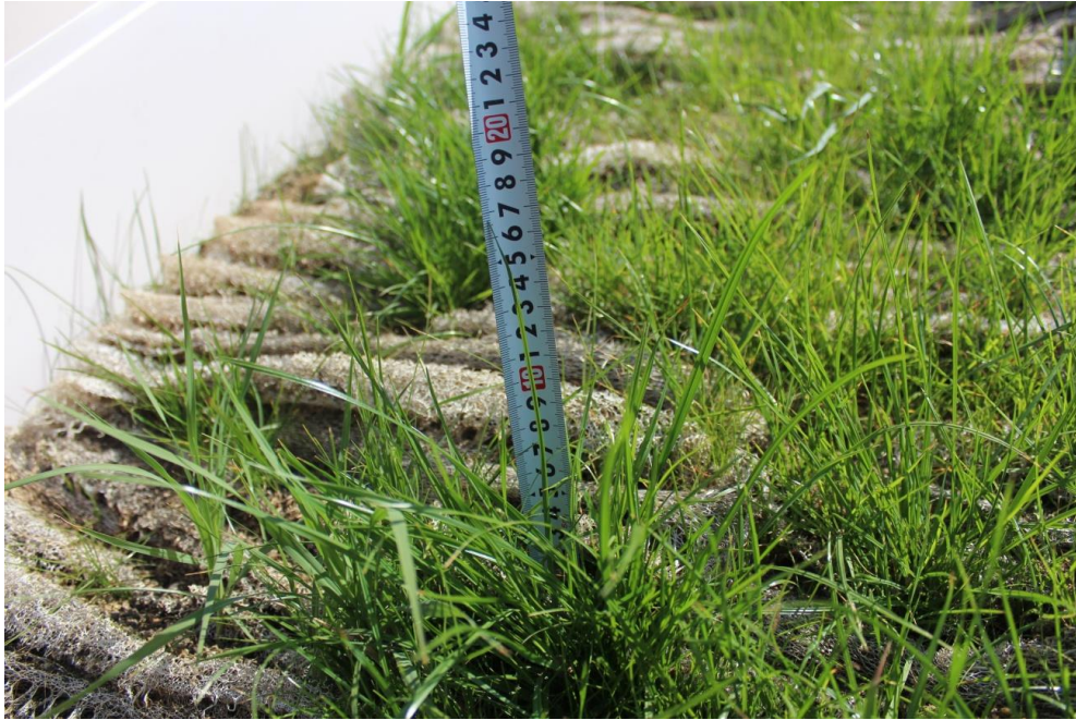
ფოტო 2.2.6. გეობალიჩა ლუფაერომატზე ამოსული მცენარეების სიმაღლის გაზომვის პროცესი
