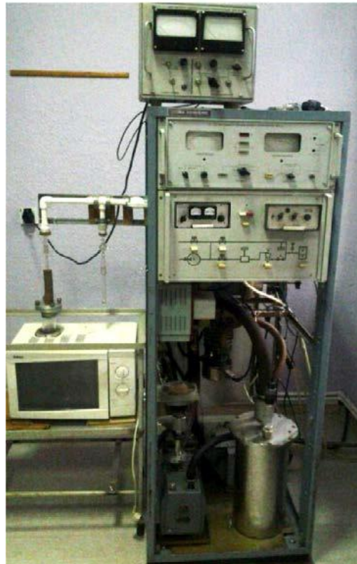
ნახ.14. ლითონის ვაკუუმური სისტემა პოლიპროპილენის ვაკუუმური მილგაყვანილობით, კვარცის რეაქტორითა და მინისგან დამზადებული ჰიდრაზინის ამპულით
