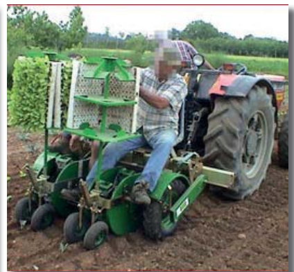
სურ. 11. მცირეკონტურიანი ნაკვეთებისთვის განკუთვნილი ჩითილსარგავი კომბინირებული მანქანა
