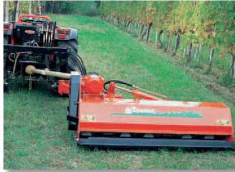
სურ. 13. მცენარეთა რიგთაშორისების დამცავი ზოლის დამამუშავებელი ფრეზი
