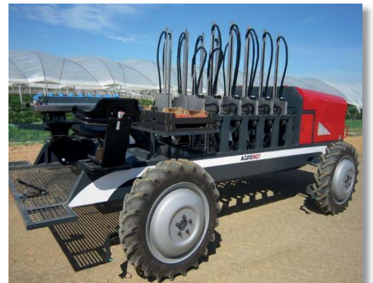
AGROBOT SW 6010 შეუძლია მარწყვი დაუზიანებლად მოკრიფოს, ავტომატურად დააკალიბროს და ყუთებში ხარისხის შესაბამისად ჩაალაგოს.
