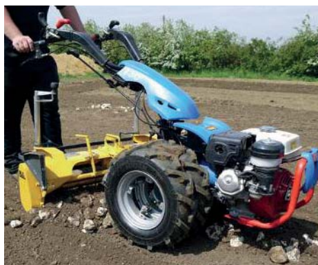
სურ. 5 ზედაპირული ქვებისგან ნიადაგის გამწმენდი მოტობლოკური აგრეგატი
