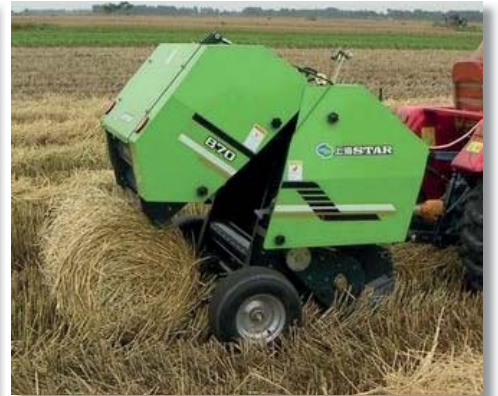
სურ. 17 მრგვალი ბარდანების დამამზადებელი მცირეგაბარიტის აგრეგატი
