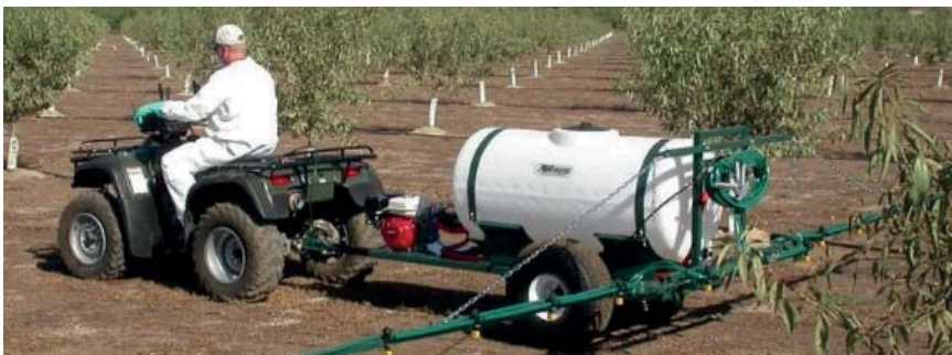
სურ. 14 პალმეტური ბაღებისთვის განკუთვნილი მინიტრაქტორზე დააგრეგატებული შემასხურებელი მანქანა
