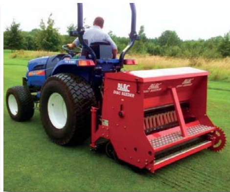
სურ. 10. მცირეკონტურიან ნაკვეთებში ბაზოების სათესი კომბინირებული მანქანა
