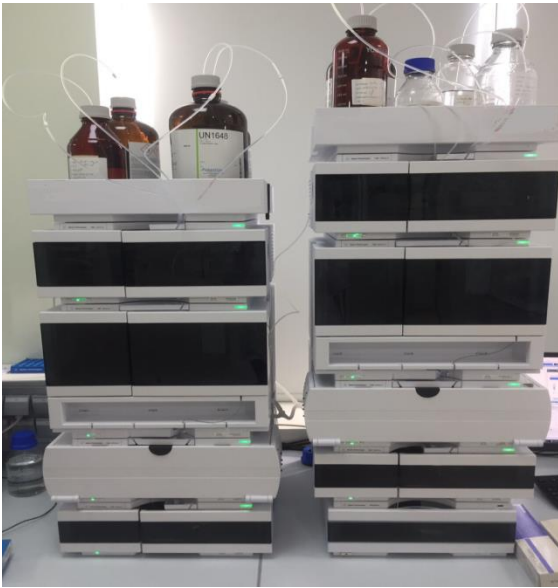
სურათი 2.6. მაღალი წნევის სითხური ქრომატოგრაფიული სისტემა
