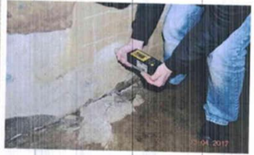
სურ. 7 ბეტონის სიმკიცის ანათვლის აღება სურ. 8 ბეტონის სიმკიცის ანათვლის აღება
