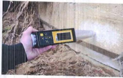
სურ. 7 ბეტონის სიმკიცის ანათვლის აღება სურ. 8 ბეტონის სიმკიცის ანათვლის აღება
