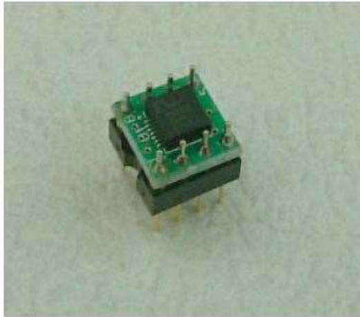
ნახ.39: KIONIX სამლერძიანი აქსელერატორი KXM52-1050(მარცხნივ), Kondo KRG-3 ჰიროსკოპი(მარცხნივ)
