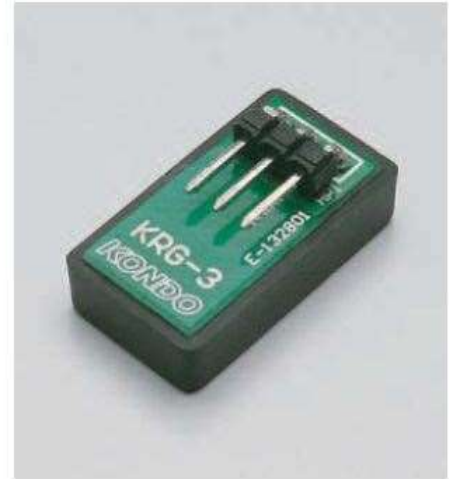
ნახ.39: KIONIX სამლერძიანი აქსელერატორი KXM52-1050(მარცხნივ), Kondo KRG-3 ჰიროსკოპი(მარცხნივ)
