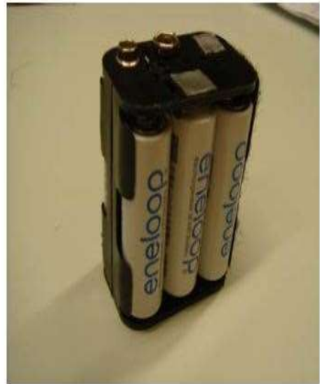
ნახ.41: Sanyo-ს დაბალი გამოყოფის NiMH ბატარეა, Eneloop (marcxniv), პროტოტიპისთვის გამოყენებული 6-AA ბატარეების შეკვრა (მარჯვნივ)
