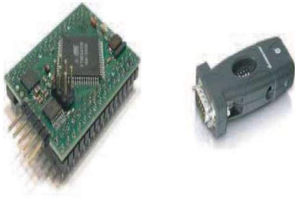
ნახ.36: CRUMB128-CAN მოდული (მარცხნივ) და IOGEAR პირველი კლასის ბლუთუზის სერიული ადამტერი(მარჯვნივ)
