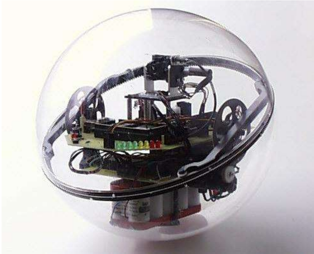
ნახ.4: TKK-ში განვითარებული მესამე თაობის „როლო“ რობოტის IDU
