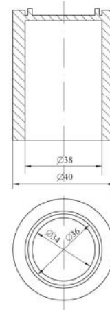
ნახ. 7. 0,12 ატმ. ვაკუუმზე გაანგარიშებული დამატებითი ზამბარის მიმმართველი ჭიქა
