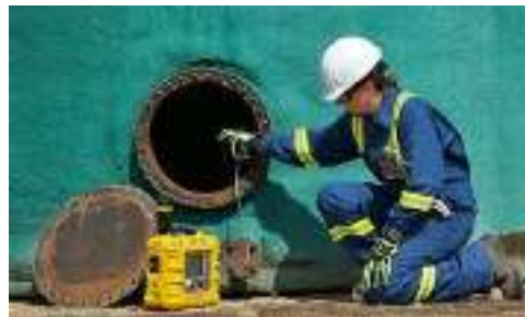
სურათი 14 - დახურულ სივრცეში მავნე აირების შემოწმება
