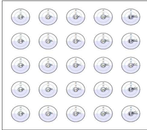
ნახაზი 40. პროგრამული პროდუქტი DIALUX-ის მეშვეობით სს ენერგო-პრო ჯორჯიას სათაო ოფისის შენობის ერთ-ერთი ოთახის ხელოვნური განათების დისკომფორტის განზოგადებული მაჩვენებლის ანგარიშის შედეგები.
