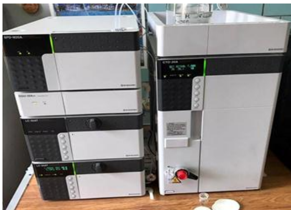
სურათი 19. მაღალეფექტური სითხური ქრომატოგრაფი (LC-20 Prominence" - Shimadzu, იაპონია )
