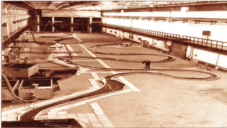
Рис. 2. Гидравлическая модель р. Иртыш с размываемым дном
