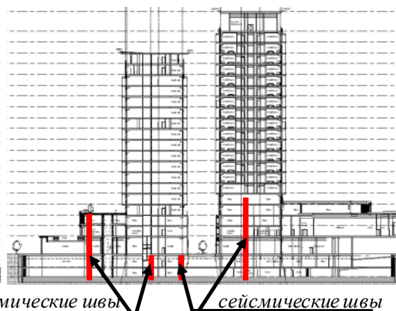
Рис. 6. Вертикальный разрез. Промежуточное решение каркаса, а красными линиями отмечены сейсмические вертикальные разделяющие швы в конструкциях по первому варианту проекта
