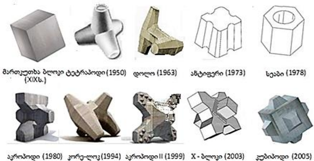
ნახ.1.17. პრაქტიკაში ხმარებული ზოგიერთი საზღვაო-საპორტო ფასონური ბლოკი დათარიღებული დაპატენტების წლებით
