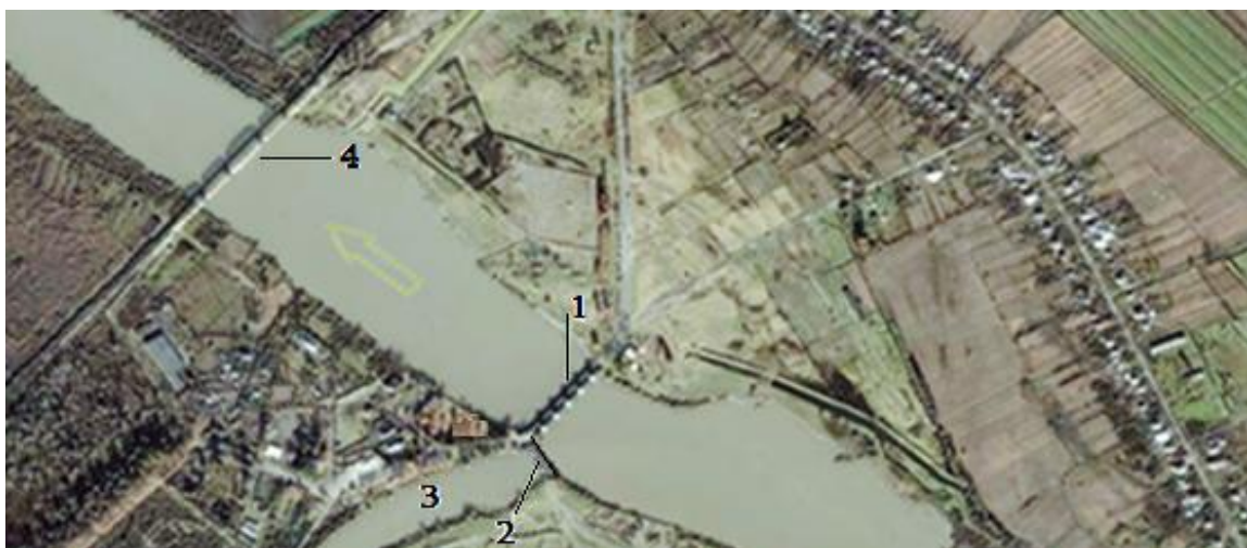
ნახ. 1.11. ქალაქ ფოთთან მდ.რიონის წყალგამყოფი ჰიდროკვანძის ხედი. 1– კაშხალ-ხიდი ფარებიანი წყალსაშვებით; 2 – რეგულატორი; 3 – ქალაქის არხი; 4 – სარკინიგზო ხიდი. ისრით ნაჩვენებია შესართავისკენ მდ.რიონის ძირითადი ნაკადის მიმართულება
