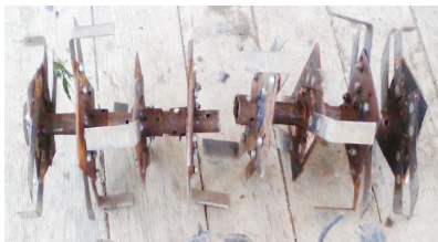
სურ. 2. ექსპერიმენტული ფრეზი, ა) აწეობილი სექციები; სურ. 3. სწორი და მოხრილი დანების ანაწეობი;
