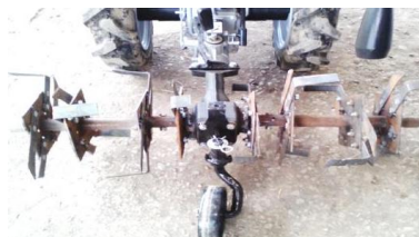
სურ. 2. ექსპერიმენტული ფრეზი, ა) აწეობილი სექციები; სურ. 3. სწორი და მოხრილი დანების ანაწეობი;
