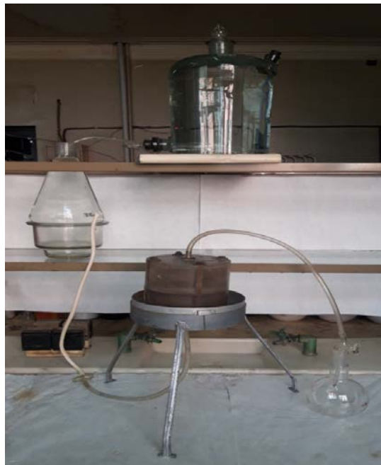
სურათი 47. დაბინძურებული წყლის გაწმენდა ჰიბირდული ნანოკომპოზიტის გამოყენებით
