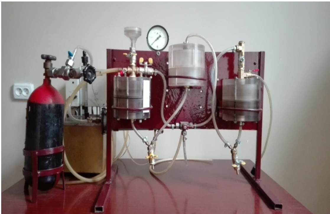
სურათი 37. კორდიერიტზე პირველადი ფენით (უოშკოტი) და კატალიზატორით გაჟღენთვის სტენდის სურათი
