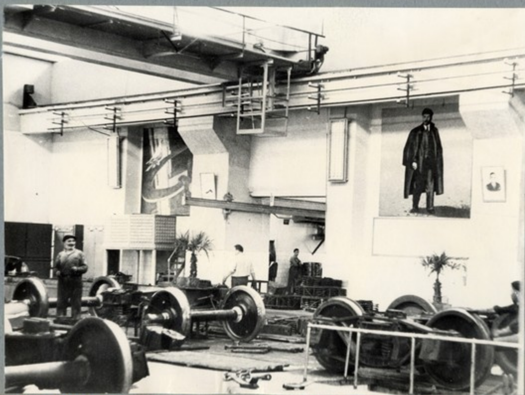
Общий вид тележечного цеха с мостовым краном и пультом управления автоматической линии
