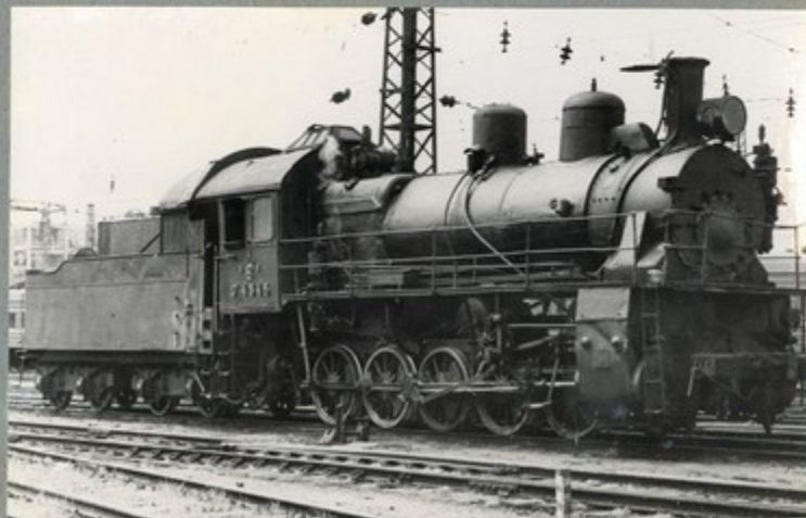
Локомотив паровоз 0-5-0 серии ЭГ построен в 1914г
