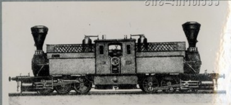
Фиг. 82. Паровоз типа 0-3-0-0-3-0 серии М Закавказской железной дороги
