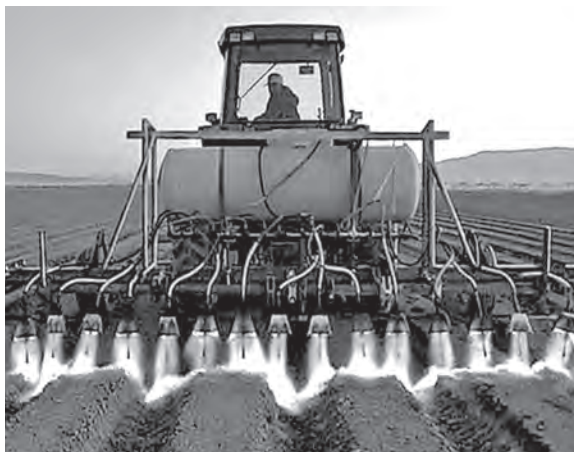
სურ. 4. უკრაინული წარმოების „ცეცხლმფრქვევი“ კულტივატორი, ბაზოზე მუშაობის დროს.
