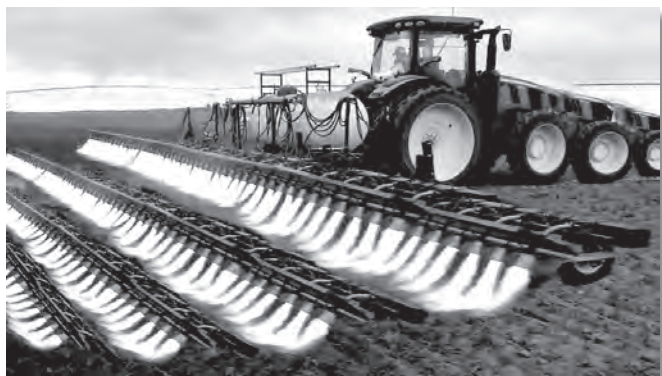
სურ. 2. „ცეცხლმფრქვევი“ კულტივატორით ნიადაგის თესვისწინა დამუშავება.
