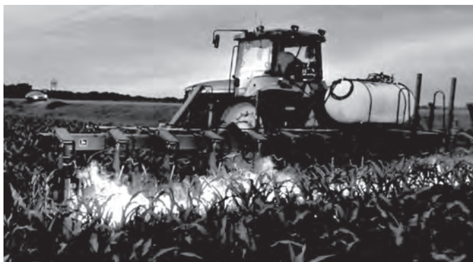
სურ.3. უკრაინული წარმოების „ცეცხლმფრქვევი“ კულტივატორი, სიმინდის ნათესებში.
