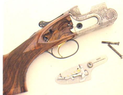
Les platines réalisées entièrement à la main sont mises au point et contrôlées attentivement pour garantir une fiabilité maximale.
