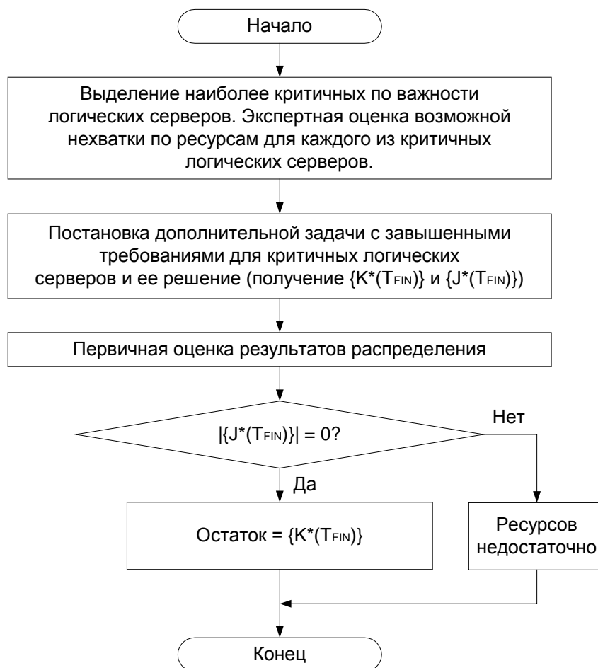
Рис. 2. Схема алгоритма вторичной оценки распределения
