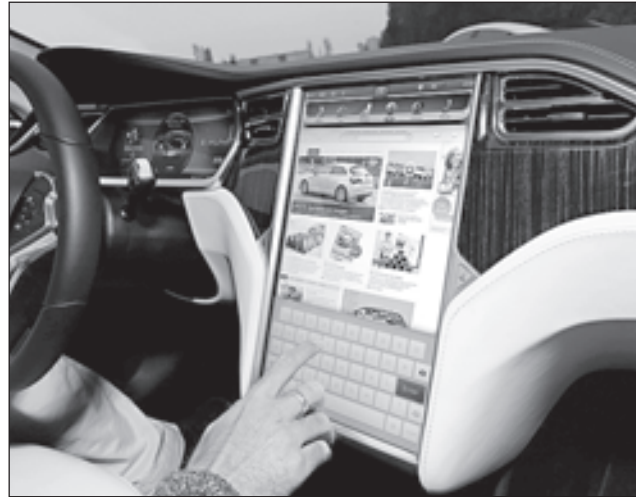
ეს ფოტო ტესლა MODEL S-ის სალონია გადაღებული. უმაღლესი ხარისხის ტყავის, უპირფარეო ხეისა და ალუმინის სხვა ავტომობილებში ვხვდებით ხოლმე. აი, 17-დღიანი მონიტორი კი არანაშუალოდ იწვევს. სენსორულ ეკრანზე, რომელიც APPLE IPAD-ზე მინიმუმ ორჯერ დიდია, ყველაფერს მართავს და კომფორტულად მართავს. TESLA-მ მომავლის ფორმატი აღმოაჩინა.
